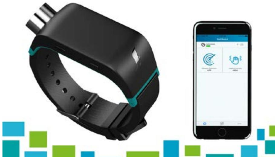
La banda Sunu es una banda inteligente de sonar que mejora la navegación para las personas con discapacidad visual. La banda Sunu combina el sonar o la ecolocalización con vibraciones suaves y precisas para informar al usuario sobre objetos u obstáculos dentro de su entorno. La banda emite una onda de sonido de alta frecuencia que rebota en los objetos que el usuario encuentra. El patrón vibratorio resultante cambia dependiendo de cuán cerca o lejos está el objeto del usuario.
